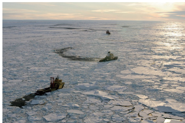
图5 IODP 302 航次首创的三船作业模式,两艘破冰船(远处)在上游破冰保障钻探船(近处)顺利作业(M. Jakobsson 摄,图片下载自 ECORD/IODP)
